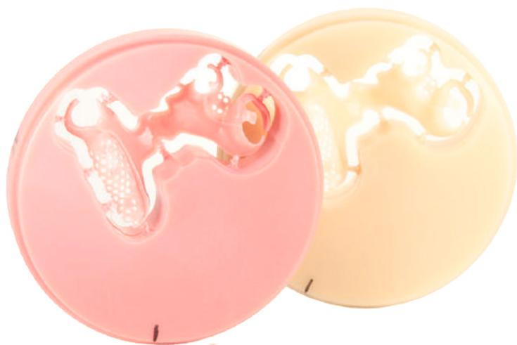
Обработка этого материала возможна со всеми фрезерными системами. Для фрезерования Acetal следует использовать фрезы без покрытия. Стратегия фрезерования на CAD/CAM должна изменяться, поскольку материал имеет другую вязкость, чем ПММА.
